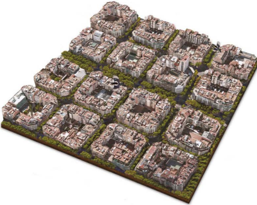
Σχήμα 73. Διαμόρφωση super blocks στη Βαρκελώνη για την αύξηση των πράσινων χώρων και την απομάκρυνση πηγών θερμότητας (κυκλοφορία οχημάτων)
